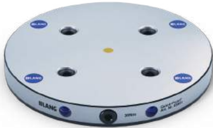
QUICK-POINT® 96, PIASTRA TONDA Ø 246 × 27 MM, CON FORI PER INTERASSE TRA LE CAVE DI 63 MM
