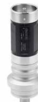
Voreinstellen: Adapter zur Aufnahme von Einsätzen für TER Spannzangen im vertikalen Schrumpfgerät. Sicheres und einfaches Einstellen der Auskraglänge ihres Fräasers während dem Schrumpfvorgang für Schrumpfspannzangen. Der Adapter ist einstellbar. Durch Drehen des Schaftes wird der eingesetzte PIN verstellt und dient als Anschlag für die Längeneinstellung eines Schneidwerkzeugs in der TER Zange während des Schrumpfens.
