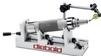
Die Prismenvorrichtung besteht aus einer Grundplatte, 2 verstellbaren, unterschiedlich hohen Prismen, einem Messuhrenständer und dem Anschlagwinkel zum Abstützen der Zentrums-kugel. Es können Prüfwellen, Prüfdorne und Spindelwellen eingelegt werden. Es gibt zwei Längen, 420 mm und 720 mm für die entsprechende Länge der Welle, die geprüft werden soll.
