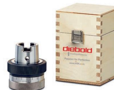
Zum Überprüfen der Zugstangenposition und Einstellen des Überwachungssensors „Werkzeug gespannt“. Die Längeneinstellung der oberen und unteren Toleranzgrenzen kann in Schritten von 0,05 mm erfolgen.
