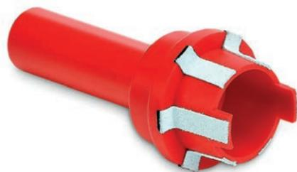
Zum Reinigen der Aufnahmekegel von HSK-Maschinenspindeln. Kunststoffkörper mit aufgeklebten Lederstreifen.
