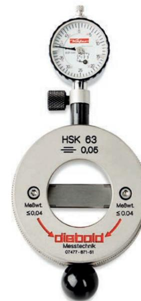
Mit diesem Messgerät kann bei der Weichbearbeitung oder in der Endkontrolle die **Nutbreite b1** und der **Mittensatz** vom Bezugspunkt „Kegelmantel“ aus geprüft werden. Es wird keine Einstelllehre benötigt.
