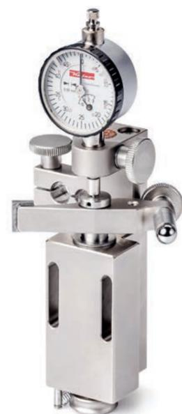
Die Messvorrichtung wird seitlich an den Messkopf geschraubt. Gleichzeitig kann der Greiferrillendurchmesser  $d_s$  und der Greiferrillenabstand  $f_1$  geprüft werden.
