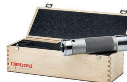
Mit Kontrollwellen wird der Rundlauf von HSK-Werkzeugaufnahmen (vorzugsweise in einer Prismenvorrichtung) geprüft. Die Werkzeugaufnahmen werden über einen eingebauten Handspanner fest eingezogen. Es ist keine Zugriffsbohrung im Kegel erforderlich. Der Spanner funktioniert auch für HSK-E und HSK-F.
