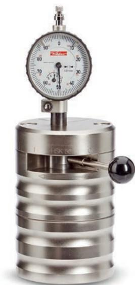
Mit diesem Messgerät kann bei der Weichbearbeitung oder in der Endkontrolle das Maß L5 mit konstanter Messkraft von der Spanschulter-schräge bis zur Plananlage geprüft werden. Das Gerät wird mit dem Einstelldorn (Seite 11) 76.750.xxx kalibriert.
