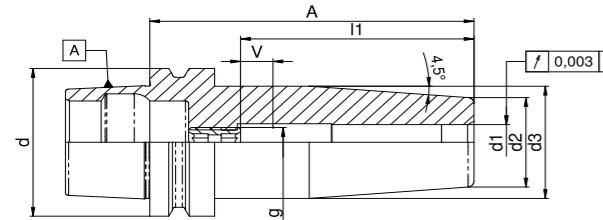
**Verwendung:** Schnelles und sicheres Spannen von Werkzeugen mit Zylinderschaft. Durch die patentierte Vorweite (ab Spanndurchmesser 6mm) schrumpfen Sie noch schneller und präziser. Ideal für hohe Drehzahlen, HPC und HSM Fräsen.
