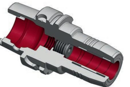
**Verwendung:** Hochgenaues Spannen von Fräswerkzeugen mit Zylinderschaft. Werkzeugschäfte nach DIN 6535 Form HA, HB, HE. Werkzeugschäfte nach DIN 1835 Form A, B mit Schafttoleranz h6.
