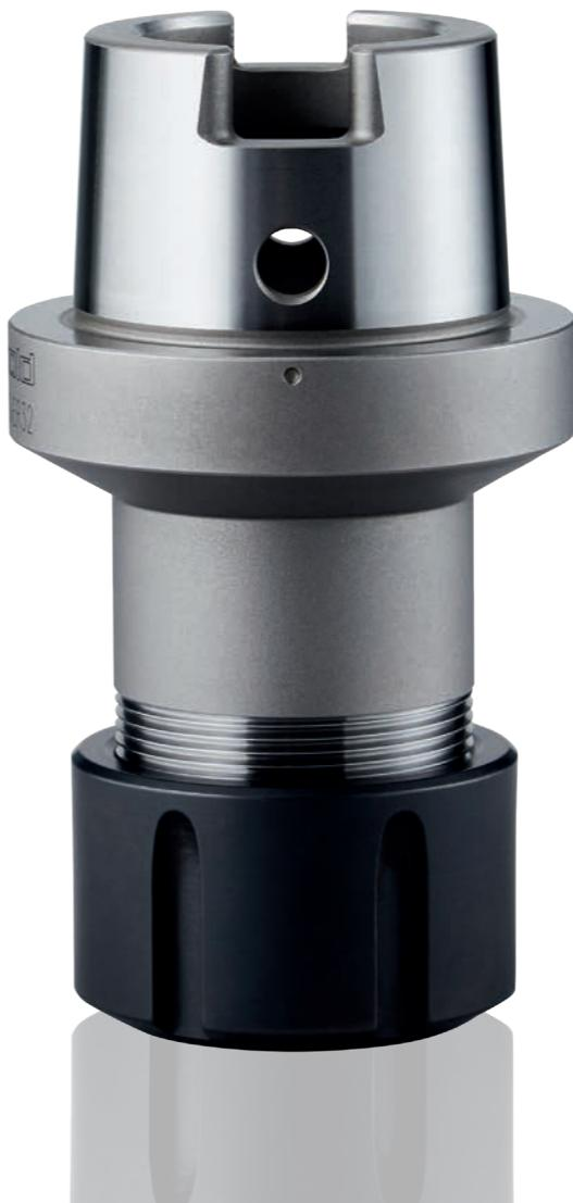
Für Spindeln mit Handspannung. Als modulares Werkzeug zum Reduzieren und zum Verlängern einsetzbar. Alle Aufnahmen sind feingewichtet < 1,6 gmm/kg. Kühlmittelzufuhr zentral durch den Spanner. Spanner dichtet ohne Kühlmittelrohr ab.
