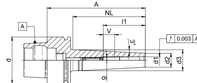
**Verwendung:** Schnelles und sicheres Spannen von Werkzeugen mit Zylinderschaft. Durch das schlanke Design verringert sich die Störkontur auf ein Minimum. Ideal für tiefe Kavitäten.
