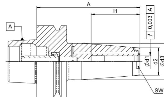
**Verwendung:** Für die Zerspannung in tiefen Kavitäten mit Düsenring für Minimalmengenschmierung.
