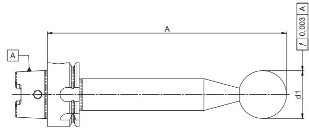
Zum Überprüfen des Rotationszentrumspunktes (RTCP) und für Positionsfehlerkompensation von Schwenkkopfspindeln. Auch für Rundlaufprüfungen verwendbar (an der Kugel).
