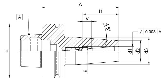
**Verwendung:** Schnelles und sicheres Spannen von Werkzeugen mit Zylinderschaft. Durch die patentierte Vorweite (ab Spanndurchmesser 6mm) schrumpfen Sie noch schneller und präziser. Ideal für hohe Drehzahlen, HPC und HSM Fräsen.
