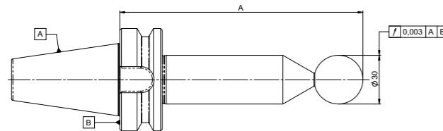
Zum Überprüfen des Rotationszentrumspunktes (RTCP) und für Positionsfehlerkompensation von Schwenkkopfspindeln. Auch für Rundlaufprüfungen verwendbar (an der Kugel).
