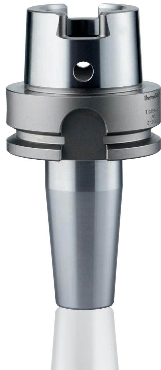
HSK Form A ist die bevorzugte Ausführung für Bearbeitungszentren für automatischen, lageorientierten Werkzeugwechsel. Alle Aufnahmen sind vor- und feingewichtet < 1,6 gmm/kg. Mit Codeträgerbohrung im Werkzeugbund. Innere Kühlmittelzufuhr über Kühlmittelrohre.
