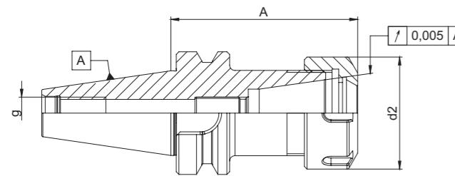
**Verwendung:** Spannen von Werkzeugen mit Zylinderschaft in der Spannzange.
