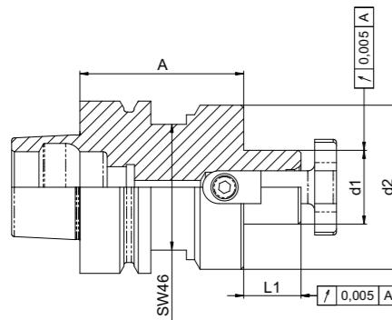
**Verwendung:** Aufnahme von Messerköpfen, Sägeblättern usw. Für zentrale Kühlmittelzuführung vorbereitet.
