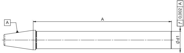
**Verwendung:** Rundlaufprüfung und Ausrichtung von Maschinenspindeln.
