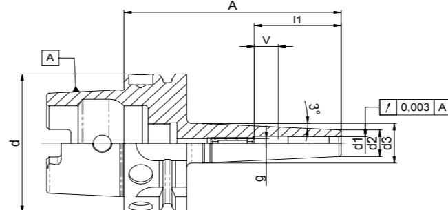
**Verwendung:** Schnelles und sicheres Spannen von Werkzeugen mit Zylinderschaft. Durch das schlanke Design verringert sich die Störkontur auf ein Minimum. Ideal für tiefe Kavitäten.
