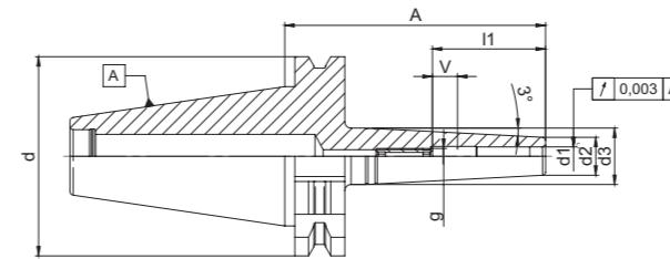
**Verwendung:** Schnelles und sicheres Spannen von Werkzeugen mit Zylinderschaft. Durch die patentierte Vorweite (ab Spanndurchmesser 6mm) schrumpfen Sie noch schneller und präziser. Ideal für hohe Drehzahlen, HPC und HSM Fräsen.
