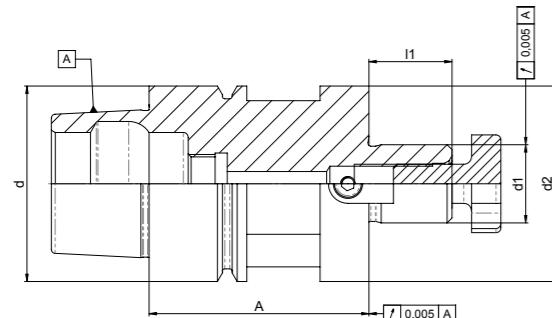
**Verwendung:** Aufnahme von Messerköpfen, Sägeblättern usw. Für zentrale Kühlmittelzuführung vorbereitet.
