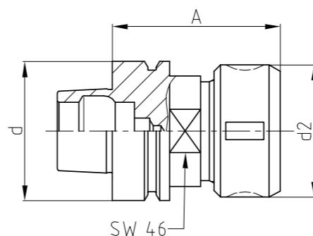
**Verwendung:** Spannen von Werkzeugen mit Zylinderschaft in der Spannzange.
