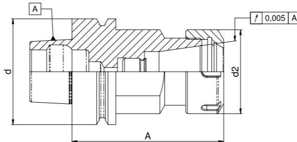
**Verwendung:** Spannen von Werkzeugen mit Zylinderschaft in der Spannzange.
