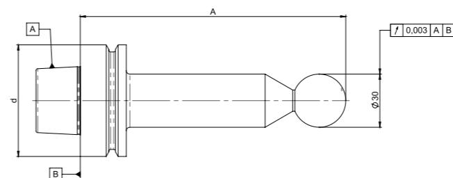
Zum Überprüfen des Rotationszentrumspunktes (RTCP) und für Positionsfehlerkompensation von Schwenkkopfspindeln. Auch für Rundlaufprüfungen verwendbar (an der Kugel).
