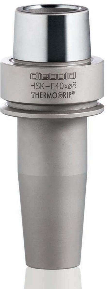
Für HSC-Maschinen mit Spindeldrehzahlen über 25 000 U/min. Absolut rotationssymmetrisch hergestellt. Drehmomentübertragung erfolgt nur durch Reibschluss. Alle Aufnahmen sind feinstgewichtet < 1 gmm/kg. Innere Kühlmittelzufuhr über Kühlmittelrohr.
