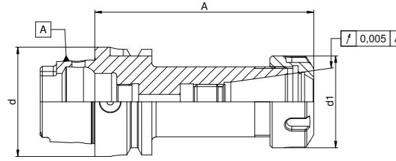
**Verwendung:** Spannen von Werkzeugen mit Zylinderschaft in der Spannzange.
