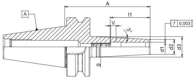
**Verwendung:** Schnelles und sicheres Spannen von Werkzeugen mit Zylinderschaft. Durch das schlanke Design verringert sich die Störkontur auf ein Minimum. Ideal für tiefe Kavitäten.
