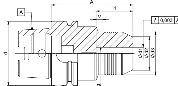
**Verwendung:** Hochgenaues Spannen von Fräswerkzeugen mit Zylinderschaft. Werkzeugschäfte nach DIN 6535 Form HA, HB, HE und tool shanks according to DIN 1835 form A, B with shank tolerances h6.
