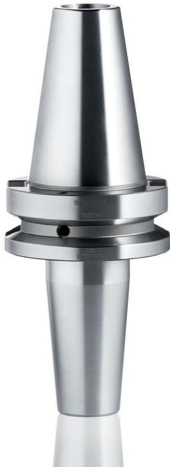
Für Maschinen mit der Steilkegelschnittstelle nach JISB 6339 und Spindeldrehzahlen unter 25.000 U/min. Ein automatischer, lageorientierter Werkzeugwechsel ist möglich. Planabstützung am Kegel. Drehmomentübertragung über Reibschluss und Mitnehmernuten. Zentrale Kühlmittelzuführung oder Zuführung über den Bund je nach Ausführung.
