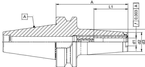
**Verwendung:** Für die Zerspannung in tiefen Kavitäten mit Düsenring für Kühlmittelapplikation.
