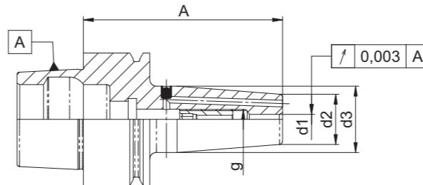
Für automatischen Werkzeugwechsel,
