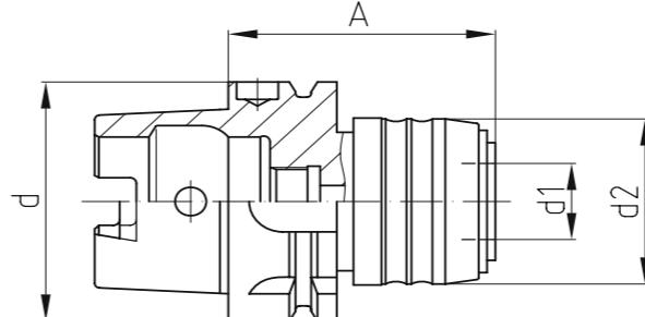
**Verwendung:** Zum Gewindeschneiden auf Bearbeitungszentren mit Synchronsteuerung.
