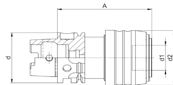
**Verwendung:** Zur Aufnahme von Schnellwechseleinsätzen mit und ohne Rutschkupplung.
