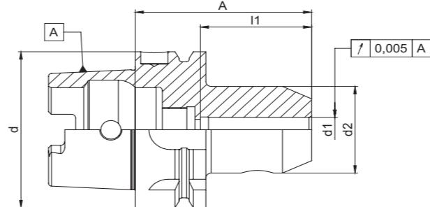
**Verwendung:** Aufnahme von Werkzeugen mit Zylinderschaft und seitlicher Spannfläche DIN 1835B und DIN 6535HB.
