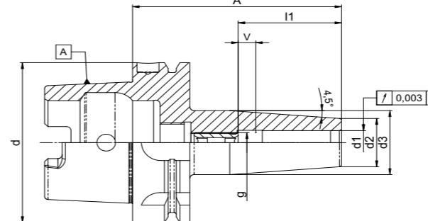
**Verwendung:** Schnelles und sicheres Spannen von Werkzeugen mit Zylinderschaft. Durch die patentierte Vorweite (ab Spanndurchmesser 6mm) schrumpfen Sie noch schneller und präziser. Ideal für hohe Drehzahlen, HPC und HSM Fräsen.
