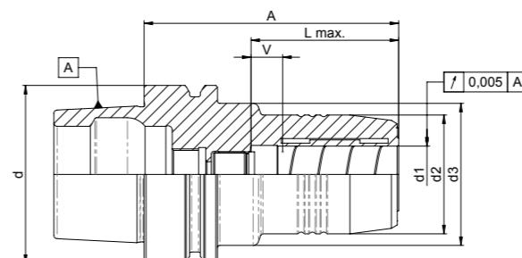
**Verwendung:** Hochgenaues Spannen von Fräswerkzeugen mit Zylinderschaft. Werkzeugschäfte nach DIN 6535 Form HA, HB, HE. Werkzeugschäfte nach DIN 1835 Form A, B mit Schafottoleranz h6.
