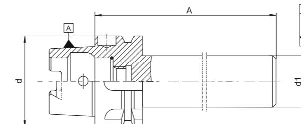
Zum Überprüfen des Rundlaufes an Maschinenspindeln und zum Ausrichten der Spindelachse.
