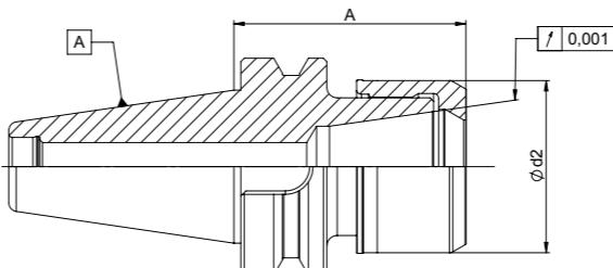
**Verwendung:** Hochgenaues Spannen von Werkzeugen mit Zylinderschaft in der Spannzange.
