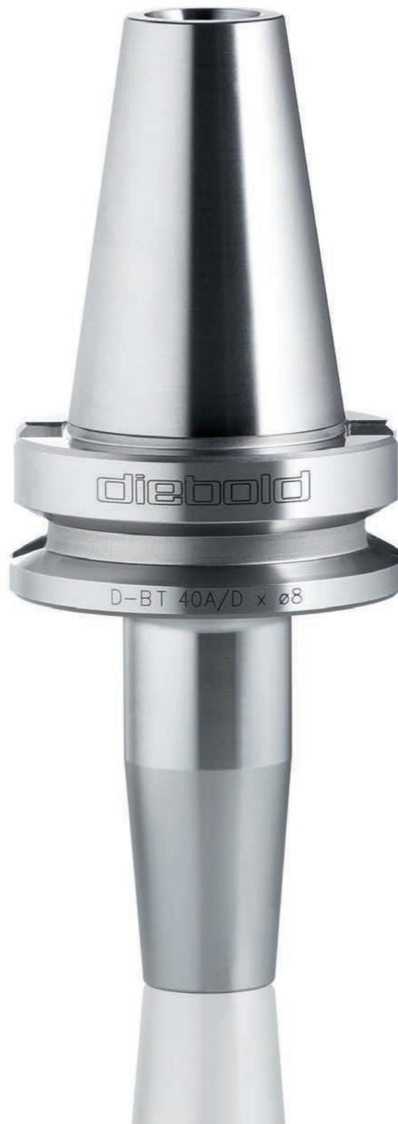
Der Diebold-BT Kegel unterscheidet sich zu einer gewöhnlichen BT-Aufnahme durch die zusätzliche Plananlage. Der Spalt zwischen Spindelnase und Werkzeugplananlage wird geschlossen. Dadurch erhält der D-BT Kegel eine höhere Steifigkeit. Bei der Schwerzerspanung und auch der Feinbearbeitung lassen sich so bessere Ergebnisse erzielen. Die Standzeit des Werkzeugs wird erhöht.
