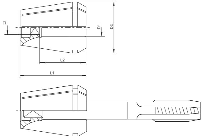
Verwendung: Spannen von Gewindebohrern mit Zylinderschaft und Vierkant.
