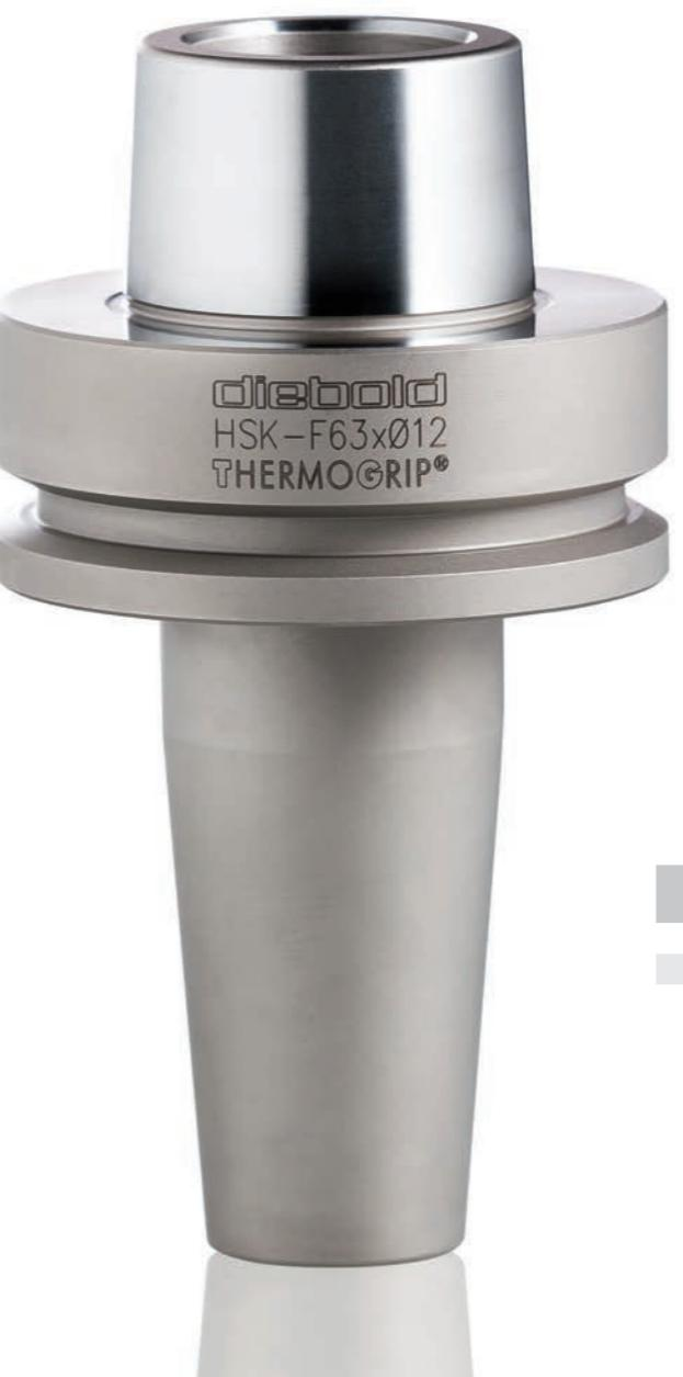
Für Maschinen in der Aluminium- und Holzbearbeitung mit Spindeldrehzahlen über 20 000 U/min. Große Planabstützung bei kleinem Kegel. Absolut rotationssymmetrisch hergestellt. Drehmomentübertragung erfolgt nur durch Reibschluss. Alle Aufnahmen sind feinstgewichtet < 1 gmm/kg. Codeträgerbohrung in der Werkzeugmitte.
