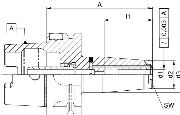
**Verwendung:** Für die Zerspannung in tiefen Kavitäten mit Düsenring für Minimalmengenschmierung.
