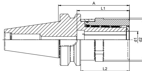
**Verwendung:** Stärkste Haltekraft auf dem Markt. Optimal für die Schwerzerspanung. Mit Düsenring für Kühlmittelapplikation.
