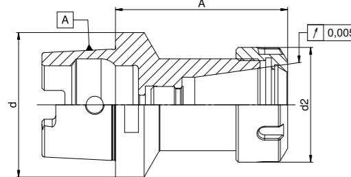
**Verwendung:** Spannen von Werkzeugen mit Zylinderschaft in der Spannzange.
