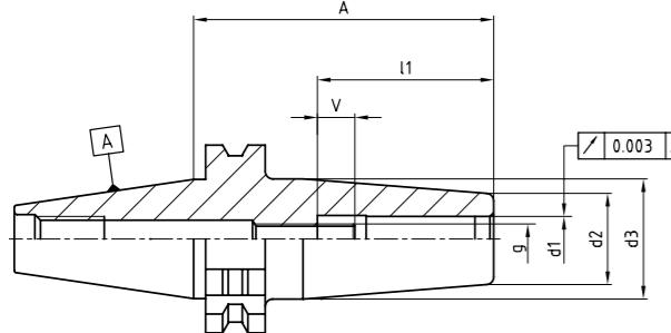
**Verwendung:** Schnelles und sicheres Spannen von Werkzeugen mit Zylinderschaft. Durch die patentierte Vorweite (ab Spanndurchmesser 6mm) schrumpfen Sie noch schneller und präziser. Ideal für hohe Drehzahlen, HPC und HSM Fräsen.
