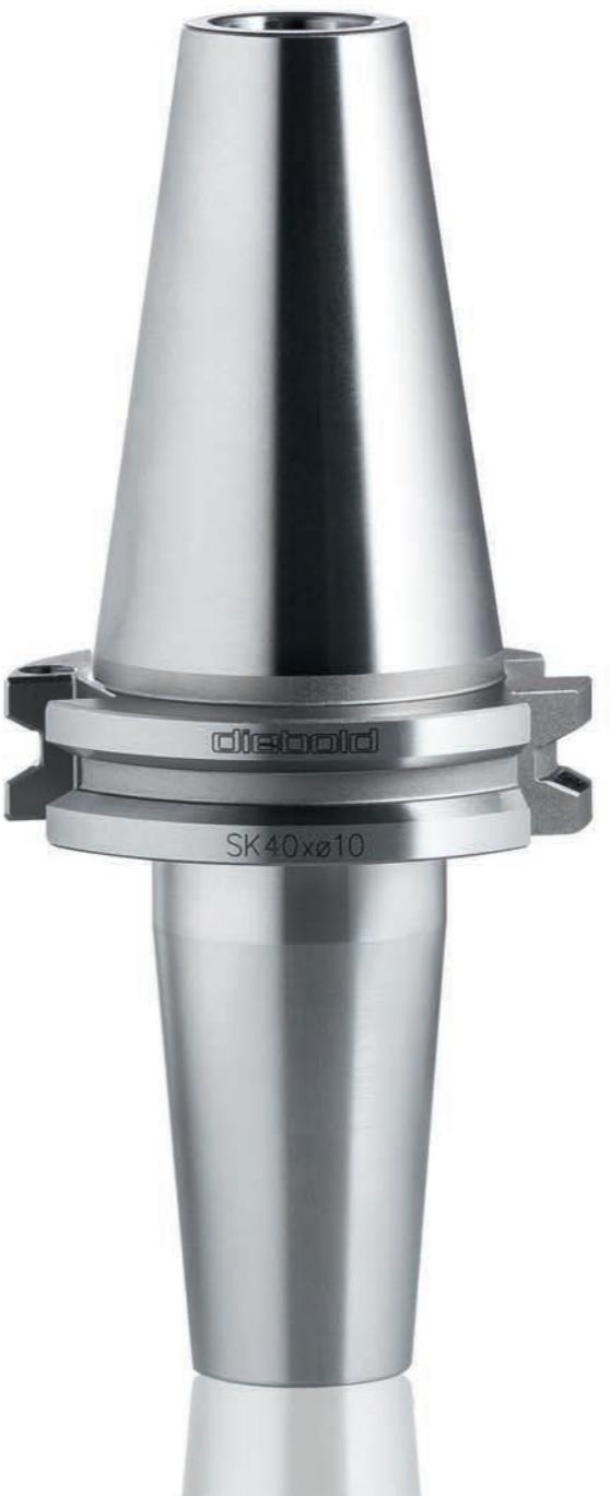
Für Maschinen mit der Steilkegelwerkzeugschnittstelle nach DIN 69871 Form A und Spindeldrehzahlen bis 25 000 U/min. Ein automatischer, lageorientierter Werkzeugwechsel ist möglich. Keine Planabstützung am Kegel. Drehmomentübertragung über Reibschluss und Mitnehmernuten. Zentrale Kühlmittelzuführung bei Form D, Zuführung über den Bund bei Form B.
