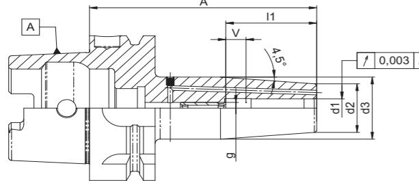
**Verwendung:** Schnelles und sicheres Spannen von Werkzeugen mit Zylinderschaft. Durch die patentierte Vorweite (ab Spanndurchmesser 6mm) schrumpfen Sie noch schneller und präziser. Ideal für hohe Drehzahlen, HPC und HSM Fräsen.
