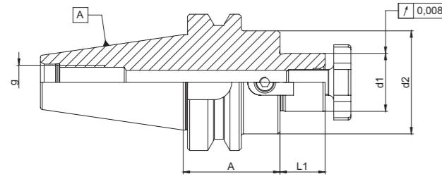
**Verwendung:** Aufnahme von Messerköpfen und Fräsern mit Quernut DIN 1880.
