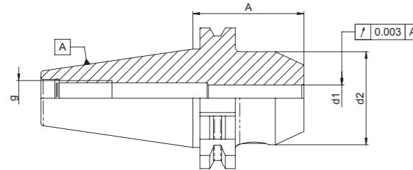
**Verwendung:** Aufnahme von Werkzeugen mit Zylinderschaft und seitlicher Spannfläche DIN 1835 B.
