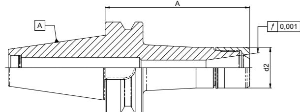
**Verwendung:** Hochgenaues Spannen von Werkzeugen mit Zylinderschaft in der Spannzange.
