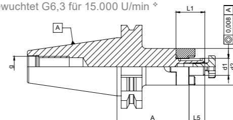
**Verwendung:** Aufnahme von Walzenstirnfräsern DIN 841 und Winkelstirnfräsern DIN 842 mit Längsnut, Walzenstirnfräsern DIN 180 mit Quernut und Fräsenmesserköpfen DIN 1830.
