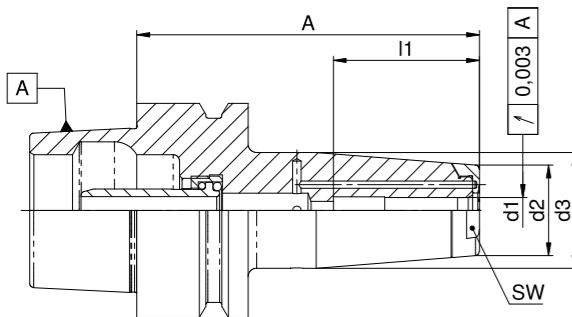
**Verwendung:** Für die Zerspannung in tiefen Kavitäten mit Düsenring für Kühlmittelapplikation.
