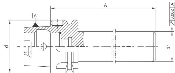
Zum Überprüfen des Rundlaufes an Maschinenspindeln und zum Ausrichten der Spindelachse.
