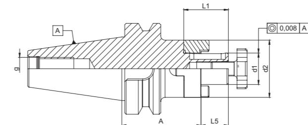
**Verwendung:** Aufnahme von Walzenstirnfräsern DIN 841 und Winkelstirnfräsern DIN 842 mit Längsnut, Walzenstirnfräsern DIN 180 mit Quernut und Fräsenmesserköpfen DIN 1830.
