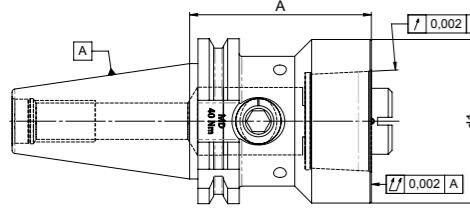
**Verwendung:** Reduzierung von Steilkegel auf HSK-Schnittstelle.
