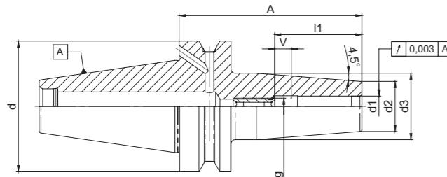
**Verwendung:** Schnelles und sicheres Spannen von Werkzeugen mit Zylinderschaft. Durch die patentierte Vorweite (ab Spanndurchmesser 6mm) schrumpfen Sie noch schneller und präziser. Ideal für hohe Drehzahlen, HPC und HSM Fräsen.
