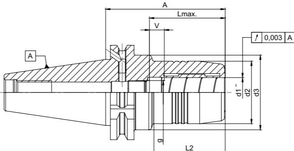
**Verwendung:** Hochgenaues Spannen von Fräswerkzeugen mit Zylinderschaft. Werkzeugschäfte nach DIN 6535 Form HA, HB und HE. Werkzeugschäfte nach DIN 1835 Form A und B mit Schaffttoleranz h6.
