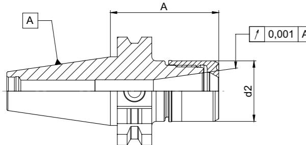
**Verwendung:** Hochgenaues Spannen von Werkzeugen mit Zylinderschaft in der Spannzange.
