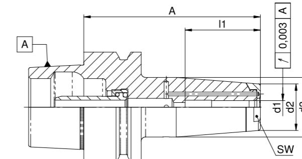
**Verwendung:** Für die Zerspannung in tiefen Kavitäten mit Düsenring für Minimalmengenschmierung.
