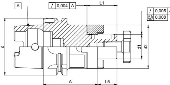
**Verwendung:** Aufnahme von Walzenstirnfräsern DIN 841 und Winkelstirnfräsern DIN 842 mit Längsnut, Walzenstirnfräsern DIN 180 mit Quernut und Fräsermesserköpfen DIN 1830.
