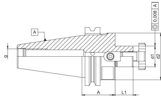
**Verwendung:** Aufnahme von Messerköpfen und Fräsen mit Quernut DIN 1880.
