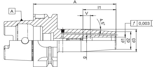
**Verwendung:** Schnelles und sicheres Spannen von Werkzeugen mit Zylinderschaft. Durch die patentierte Vorweite (ab Spanndurchmesser 6mm) schrumpfen Sie noch schneller und präziser. Ideal für hohe Drehzahlen, HPC und HSM Fräsen.
