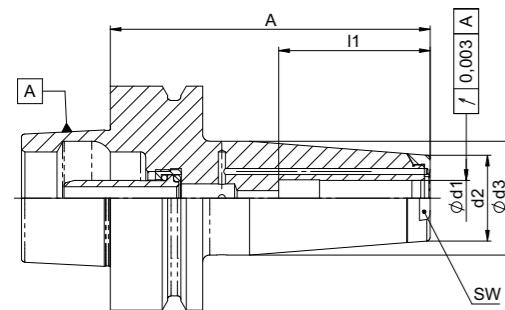
**Verwendung:** Für die Zerspannung in tiefen Kavitäten mit Düsenring für Kühlmittelapplikation.
