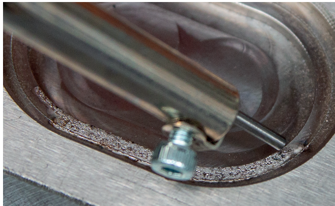
Rivestimento in metallo duro di un componente
