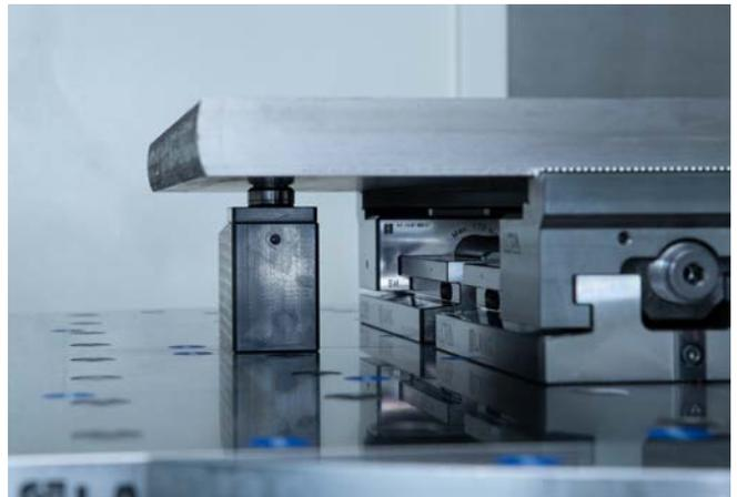
Il martinetto idraulico, che viene azionato tramite una chiave a bussola, si adatta al pezzo da lavorare con il suo supporto a pendolo e riduce le vibrazioni, il che contribuisce ad aumentare la qualità della superficie.
