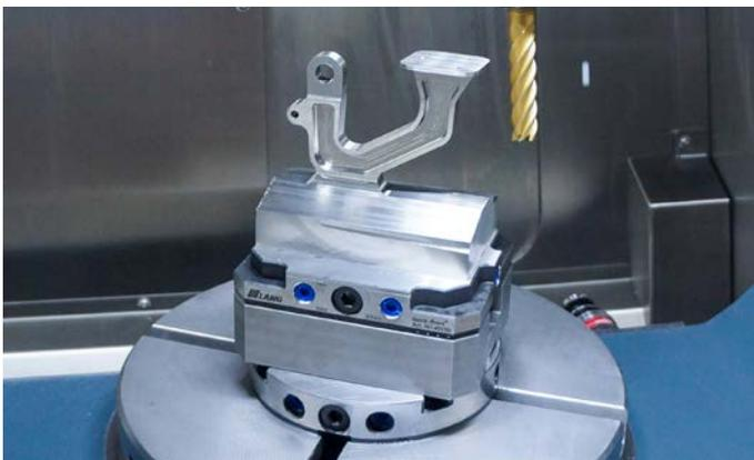
Senza morsa, il pezzo viene bloccato direttamente e in modo sicuro nel sistema a punto zero.
