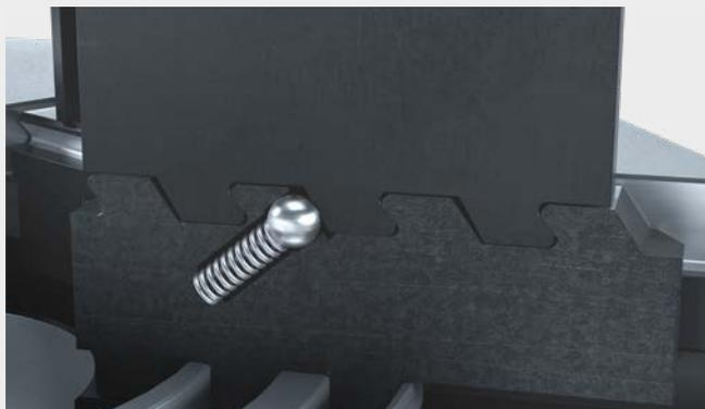
Una sfera di pressione a molla nella ganascia di base assicura la tensione della ganascia superiore
