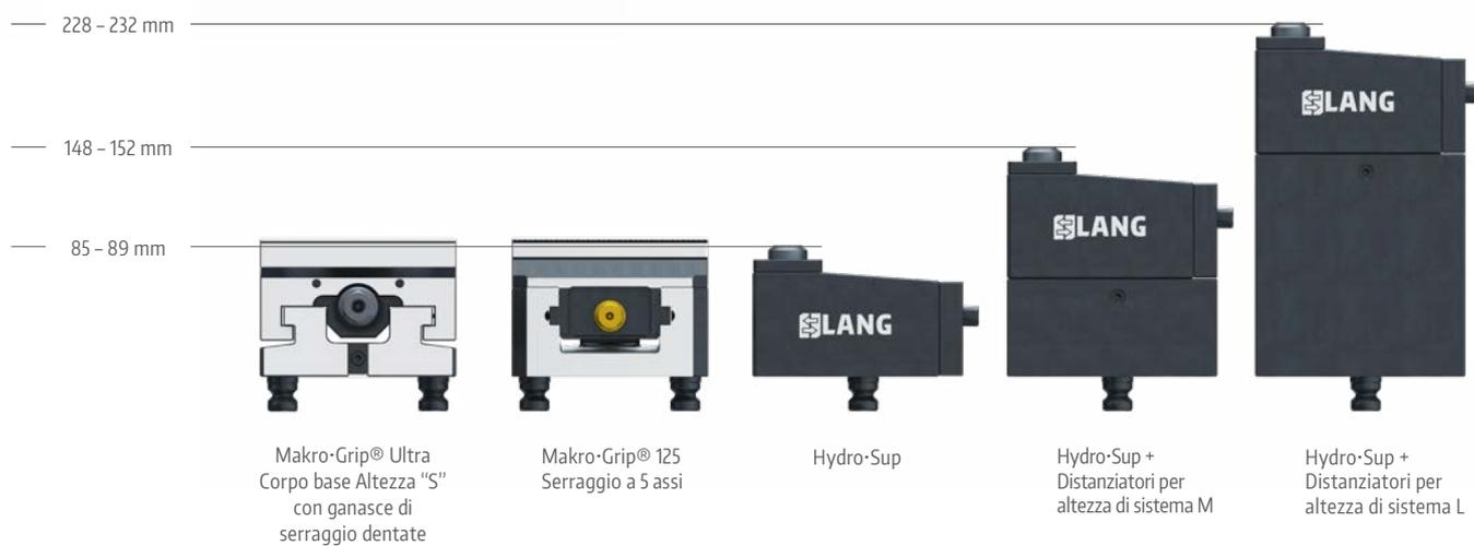
Con i suoi due distanziali, il martinetto idraulico può essere utilizzato in tutte le altezze del sistema Makro-Grip® Ultra. Può anche essere usato con il serraggio a 5 assi Makro-Grip5125 per fornire un supporto aggiuntivo per pezzi larghi.
