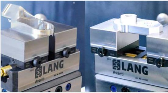
Con il sistema brevettato di ganasce a cambio rapido, sia nel senso della lunghezza che in quello trasversale, è possibile adattare un'ampia varietà di contorni con un'accessibilità ottimale. Grazie al volume massimo utilizzabile delle ganasce superiori, è anche possibile inserire diversi contorni in una coppia di ganasce.
