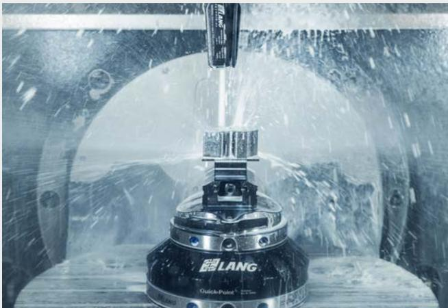
Un canale integrato attraverso il corpo di base della pulitrice ad eliche rende possibile il risciacquo di pezzi e attrezzature - **con il mandrino fermo!**
