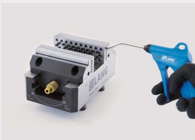
Per garantire il funzionamento dei perni in ogni momento, essi devono essere soffiati e puliti con aria compressa alla fine di ogni lavorazione per evitare l'intasamento dovuto al refrigerante. Si raccomanda di spruzzare occasionalmente con olio multifunzione per la capacità di scorrimento dei perni.
