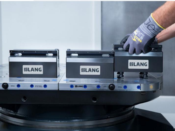
Estensione dell'area di serraggio tramite l'aggiunta di corpi base
