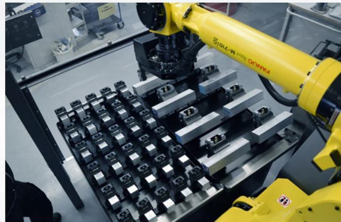
RoboTrex 96 con interfaccia il cambio pinze e diversi carrelli di automazione.
