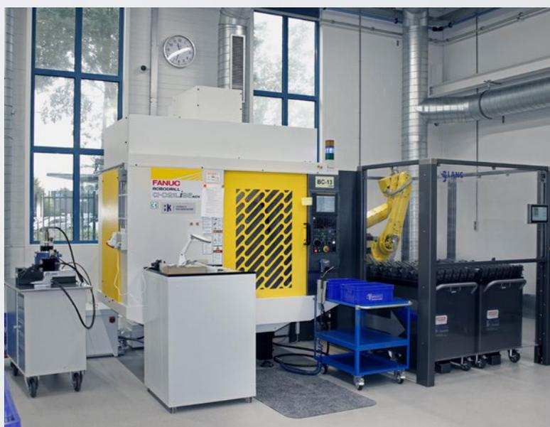
Fanuc Robodrill con il sistema di automazione RoboTrex 52. (foto: Vedos Verspanende Techniek B.V.)
