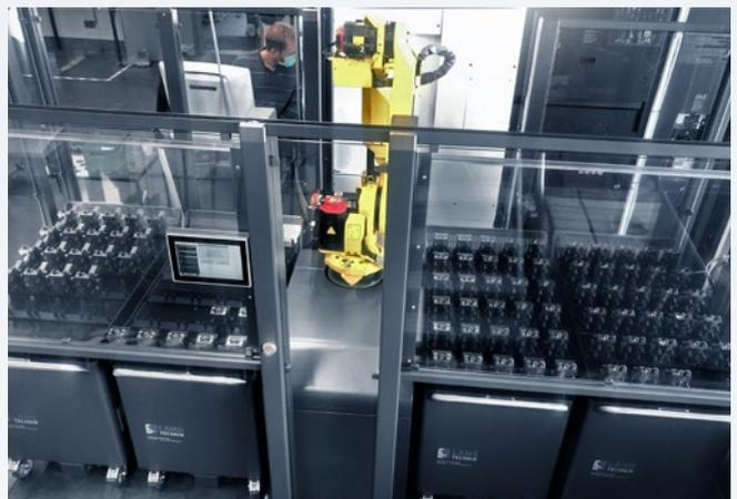
RoboTrex 52 con quattro carrelli di automazione su una DMU 60evo.
