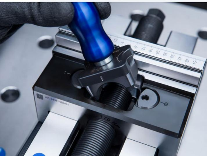
Rapida regolazione innovativa delle ganasce tramite inserti filettati rimovibili
