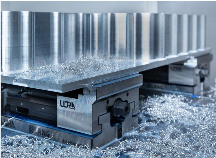
Lavorazione di pezzi grezzi con le ganasce di serraggio Makro-Grip® Ultra.
