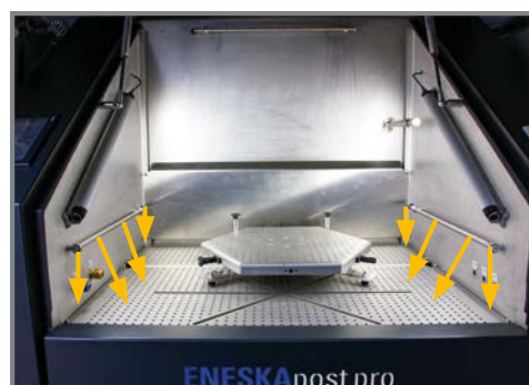
Dopo la fase di lavorazione, l'impianto può essere aperto solo a conclusione di uno speciale processo di pulizia automatico, durante il quale i residui di polvere depositatisi negli angoli del vano sono alzati ed aspirati.
