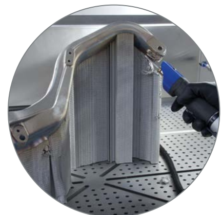
Impiego della limatrice ad aria compressa
