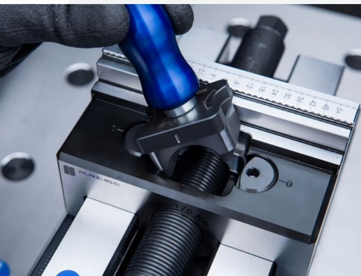
Innovative Backenschnellverstellung über entnehmbare Gewindeeinsätze
