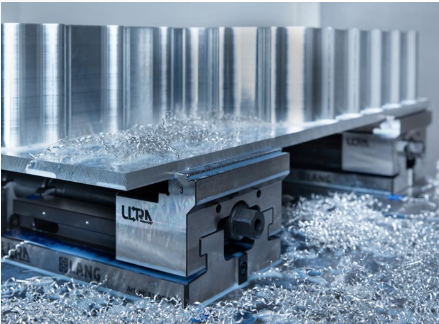
Rohteilbearbeitung mit verzahnten Makro-Grip® Ultra Spannbacken.
