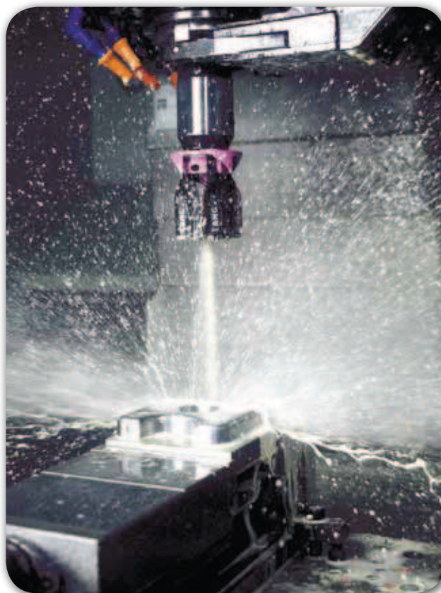
Se necessario, pulire pezzi e dispositivi con mandrino fermo mediante Clean•Tec con refrigerante.
