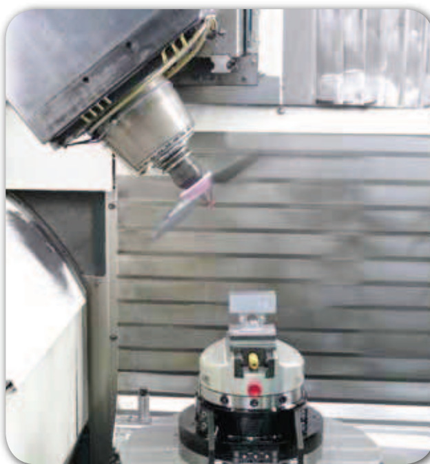
Ideale per la pulizia dei pezzi prima di un prelievamento automatico
