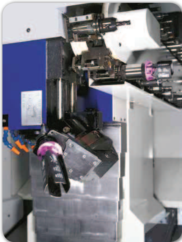
Cambio automatico dal magazzino utensili
