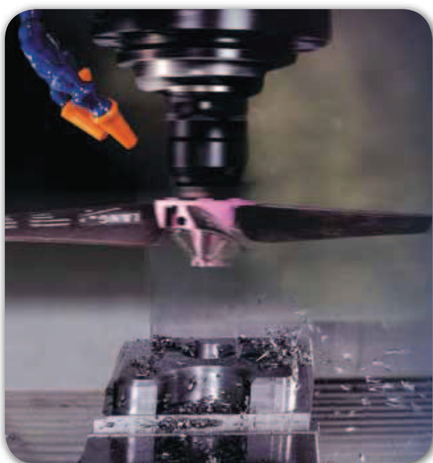
Con mandrino rotante a una distanza di circa 100 – 150 mm mediante procedimento con avanzamento di 3 – 10 m/min. Pulire il pezzo con getto d'aria.
