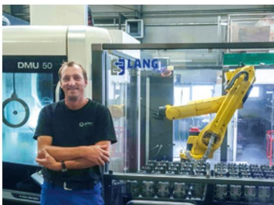
Il RoboTrex è un prodotto tecnicamente valido, dall'ottimo rapporto qualità-prezzo e poco ingombrante. LANG Technik è in grado di immagazzinare un gran numero di parti su un ingombro minimo. Uno dei grandi vantaggi del sistema: grazie all'interfaccia modulare può essere collegato a qualsiasi macchina utensile, indipendentemente dal produttore della macchina.
