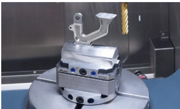
Il pezzo da lavorare viene serrato direttamente nel sistema punto zero in modo affidabile e senza necessità di morse.
