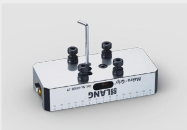
Ruotare la morsa e rimuovere le due viti di montaggio.
