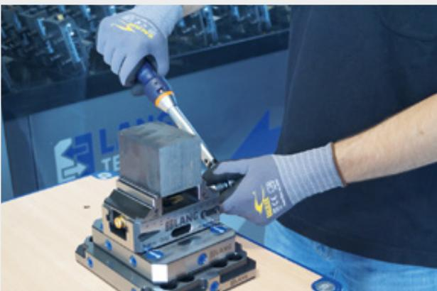
Per serrare i pezzi sempre con la stessa forza di serraggio e garantire quindi l'affidabilità del processo, raccomandiamo l'uso di una chiave dinamometrica standard.
