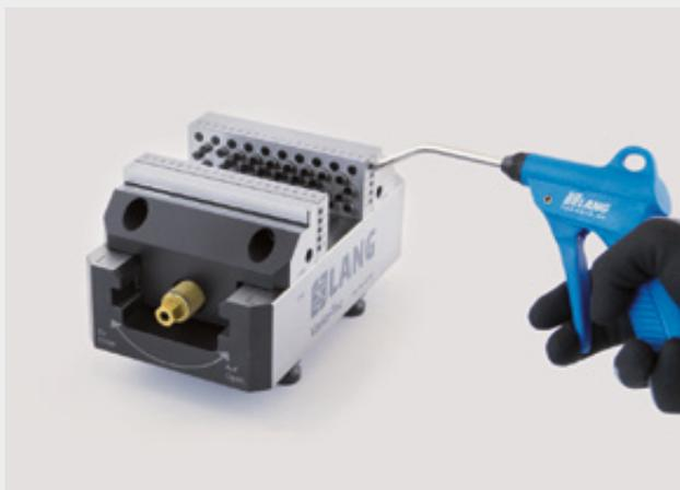
Per garantire sempre la funzione dei perni, alla fine di ogni lavorazione questi devono essere soffiati fuori e puliti con aria compressa per evitare la resinificazione del refrigerante. Si raccomanda l'irrorazione occasionale con olio multifunzione per lo scorrimento dei perni.
