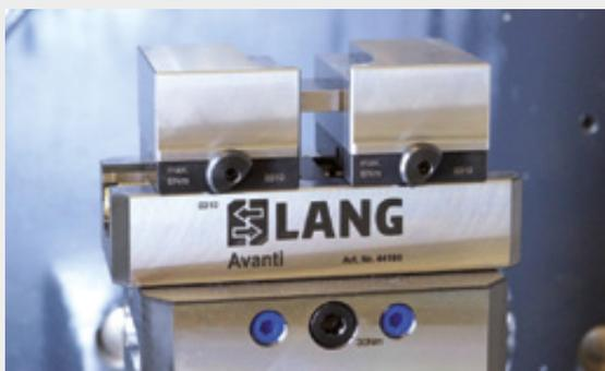
Che sia allungato longitudinalmente o trasversalmente - nel sistema brevettato a cambio rapido di ganasce, è possibile scegliere un'ampia varietà di profili ad ottima accessibilità. Attraverso il massimo volume sfruttabile delle ganasce riportate, inoltre, è possibile anche la realizzazione dei profili più diversi in un paio di ganasce.
