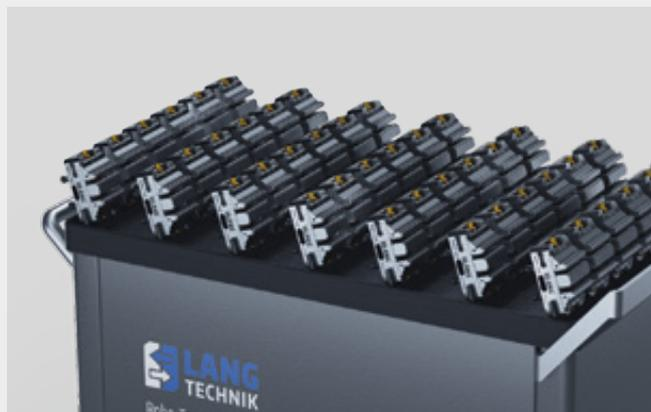
La ganasca centrale è ora disponibile anche per le morse Makro-Grip® di Robo-Trex Automation, aumentando la capacità di stoccaggio fino a un massimo di 336 parti.
