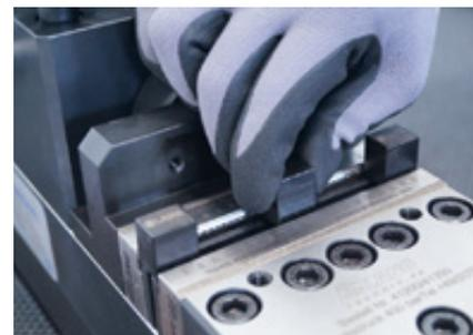
Se la pietra di misura si adatta tra i denti di coniatura, le ganasce devono essere inviate per la rilavorazione.
